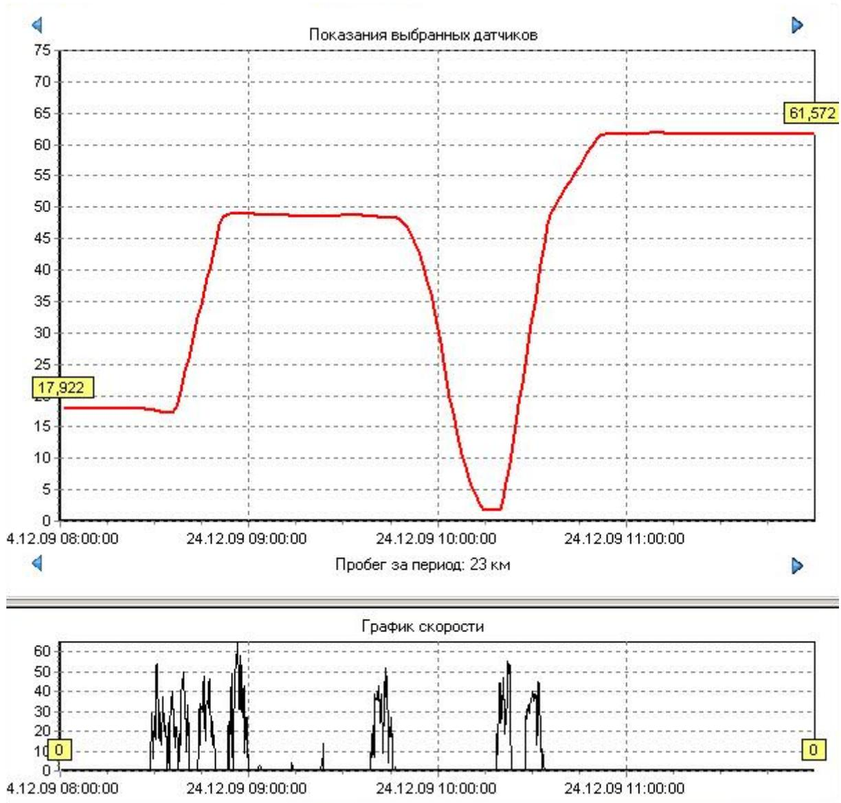
Рис.3. Контроль уровня топлива в баке транспортного средства
